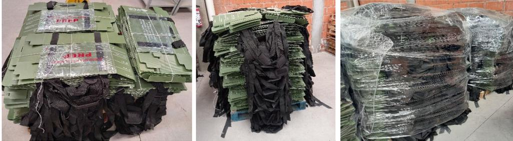
5. Una vez que las cajas en mal estado se clasificaron, se separan, se les retiran todas las piezas de plástico y las cintas de polipropileno para su desincorporación y reutilizar las piezas.
